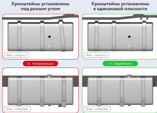
Рис. 2 — Схема установки кронштейнов на топливный бак
